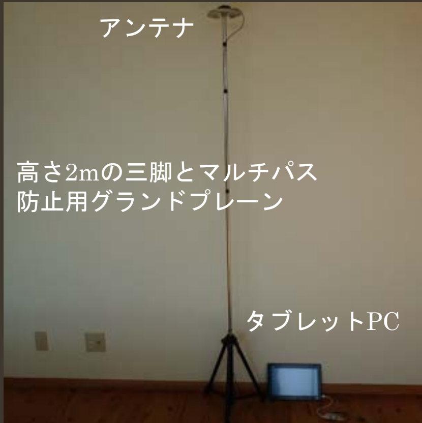
高さ 2 mのアンテナ（三脚改造）と タブレットパソコン
